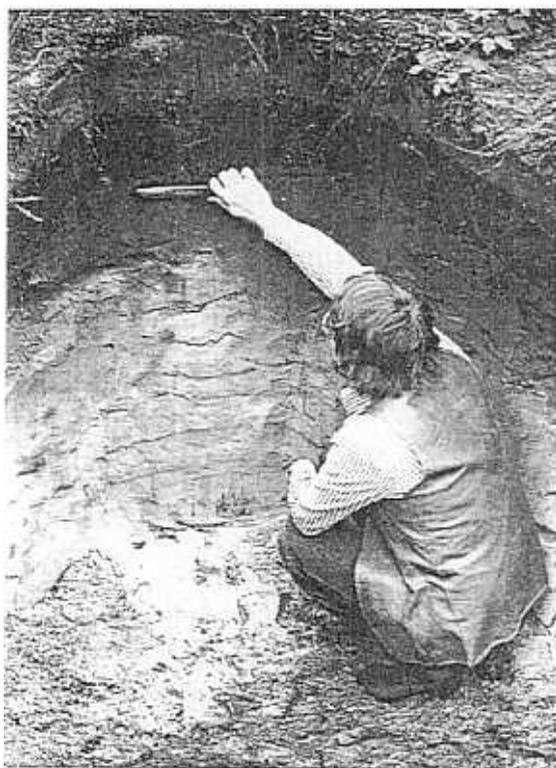
**Fig. 8. Se excava una calicata suficientemente amplia y se alisa una de las paredes**
